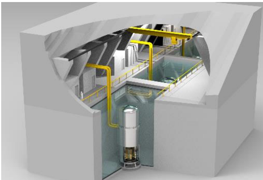
Ydinlämpölaitos sijoitettuna maan alle
